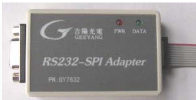
图 2 GY7632 RS232-SPI 适配器外观图
